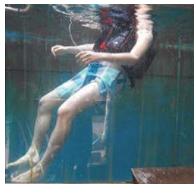
水上性能試験 着用者が水上に顔を出し、後傾姿勢で浮く事を確認します。
