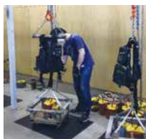
荷重試験 吊下げ部の強度試験。 大人用880N(約90kg)/5分。 小児用、幼児用580N(約59kg)/5分
