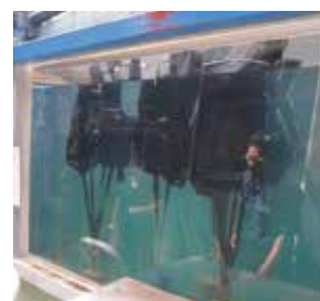
浮力試験 水中で規定質量のおもりを吊り下げ、24時間以上浮く事を確認します。 ※大人用11.7kg(L1)・7.5kg(L2)、小児用5kg(LC1)、幼児用4kg(LC2)
