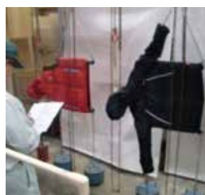
荷重試験 胸部の強度試験。 大人用880N(約90kg)/5分。 小児用、幼児用580N(約59kg)/5分
